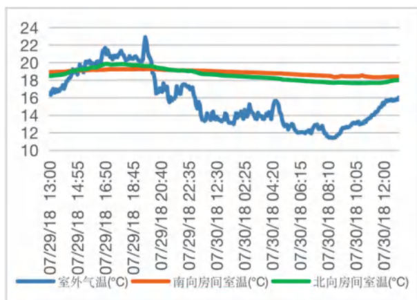
图 2-3 土坯砖墙体房间室内外空气温度
