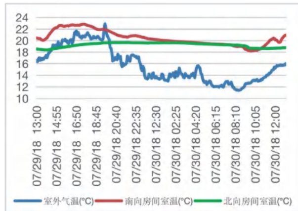
图 2-1 混凝土墙体房间室内外空气温度
